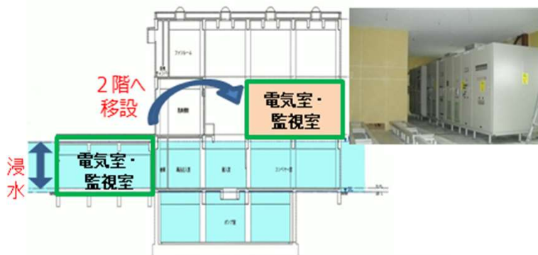
主要設備の上階への移設
