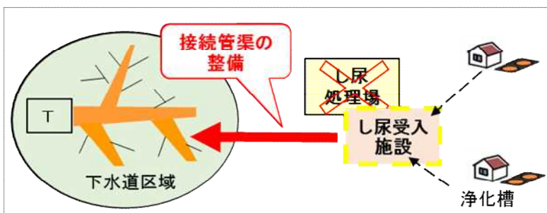
し尿処理場から下水道への接続管渠の整備
