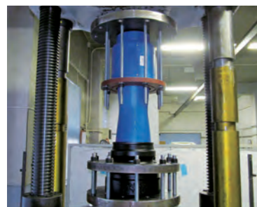
引抜阻止性試験 管が降伏するまで引っ張っても異常がありません。
